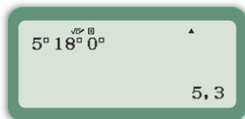
Taper  $5^{\circ}18^{\circ}0^{\circ}$  puis  $\boxed{\text{EXE}}$  puis 2 fois sur  $\boxed{\text{S}+\text{D}}$  et on obtient le résultat cherché.
